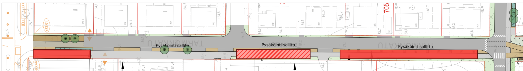
Kuva: Tarmonkadun mahdolliset katettavat osuudet on esitetty punaisella. Kadun keskiosuudella kadun rajapinnan läheisyyteen tontin puolelle sijoittuu suurikasvuista ja pitkäikäistä, tonttia suojaavaa puustoa, joiden säilyttäminen saattaa vaikuttaa katoksen toteutettavuuteen (viistoviivalla merkitty katosalue).
